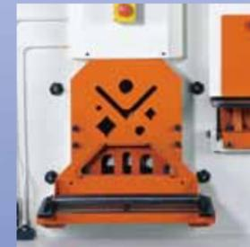
Serre-tôle hydraulique (en option sur le IW-50K).
