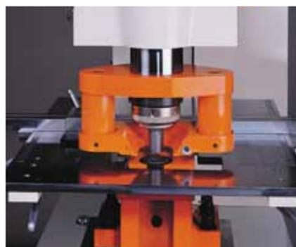
\*Extracteur mû par ressort en uréthane assure une déformation minimale.
