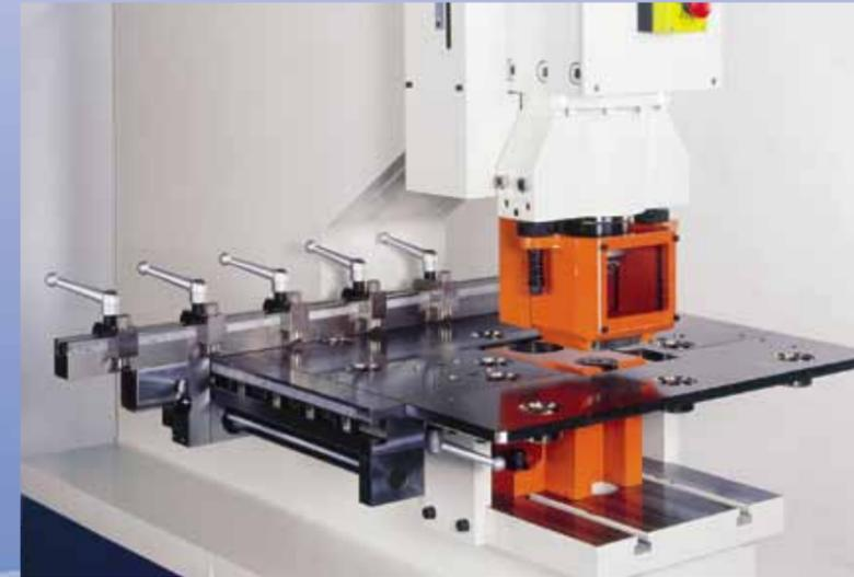
\*Table graduée avec butées multiples (modèles S, SD, KD et PM uniquement).
