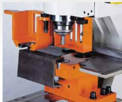
Porte-matrice en porte-à-faux standard pour le poinçonnage d'ailes de profilés U et de cornières (en option sur les modèles à un vérin).
