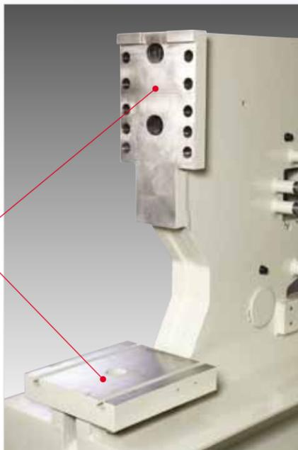
Le châssis de la machine est une pièce monobloc intégrant boulons et renforcement de soudure pour assurer la rigidité maximale de la structure du châssis.
