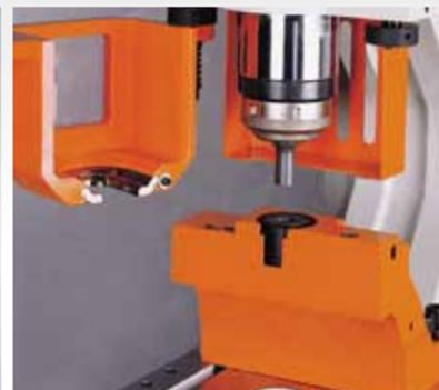
\*Porte-matrice en col de cygne pour le poinçonnage d'ailes et d'âmes de profilés U.
